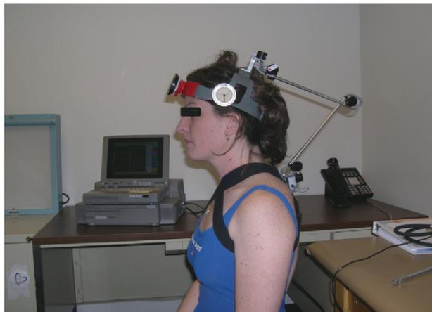
Starting position per un soggetto con il Spine Motion Analyzer.
