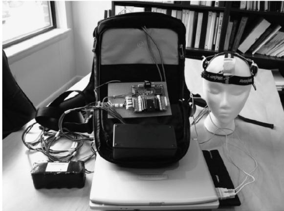
**Figura 4:** Componenti dell'apparecchio di stimolazione vibrotattile utilizzato nello studio di Goebel et al. [49]
